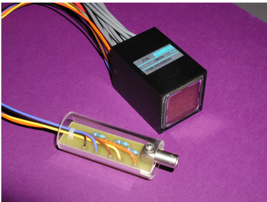
Abbildung A.3: Der Photomultiplier H6568 Booster Basis.
