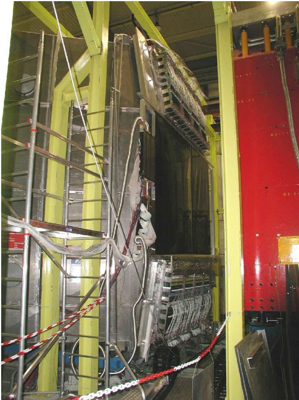
Abbildung C.7: Am Eingangsfenster des RICH-Detektors endmontierte Detektorstation FI05, inklusive Verkabelung und Kühlvorrichtung.
