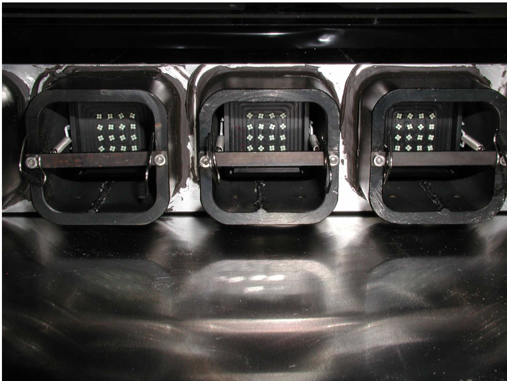
Abbildung C.5: Das Detektormodul ist in den äußeren Rahmen integriert und jeder 16er Block in eine Stahlhülse (zur Abschirmung der Magnetfelder) eingeführt und fixiert. Die Federzugmechanik in Verbindung mit den an den Stahlhülsen montierten Querstreben verbindet später Photomultiplier und Faserraster.
