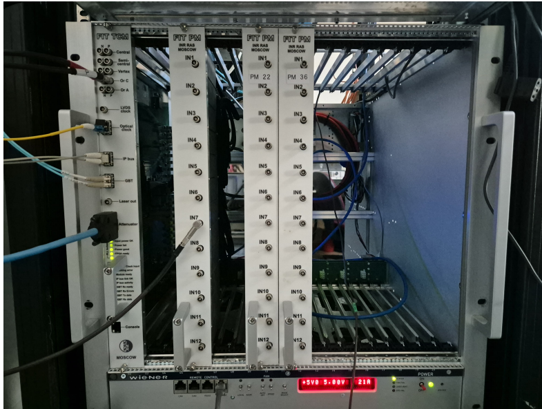
Rysunek 10. Moduły PM oraz TCM znajdujące się w laboratorium poddetektorów FIT w CERN.
