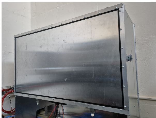
Rysunek 8. Obudowa stacji symulacyjnej detektora, wewnątrz której znajdują się fotopowielacze MCP-PMT.
