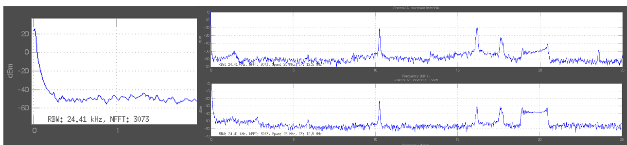
Illustration 28: Décomposition de fourrier du bruit de fond, résolveur branché et immobile (circuit ouvert). L'angle du resolver est tel qu'un des secondaires est au maximum, alors que l'autre est au minimum. L'illustration de gauche représente un zoom sur les basses fréquences de la décomposition de fourrier du retour ayant son amplitude maximale, afin de visualiser le rapport signal bruit entre la fréquence d'excitation et le bruit résiduel.
