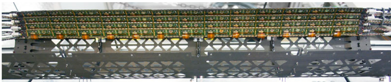
Abbildung 3.2: Halbschale (Trägerstruktur des Barrel) des Layer1 mit vier montierten Staves. [14]
