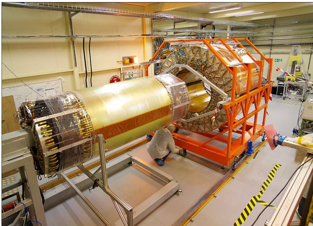
FIGURE 35 – Photographie prise lors de l'insertion du tonneau du SCT dans le tonneau du TRT. La procédure était la même pour les bouchons.
