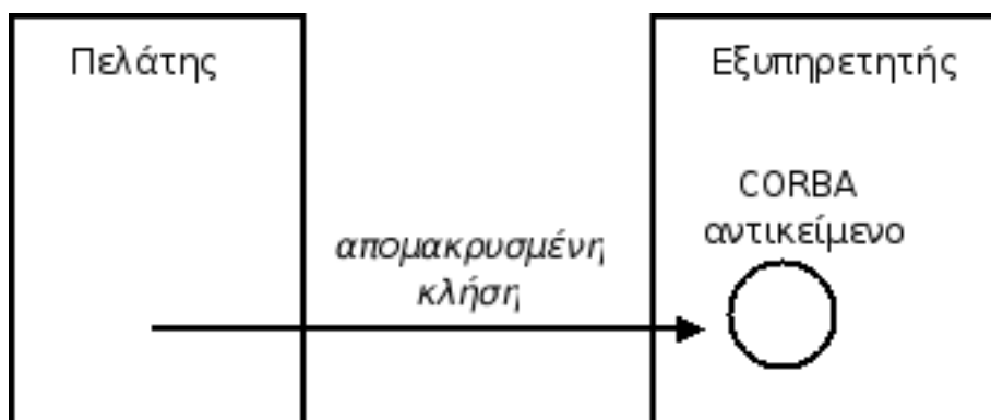
Σχήμα 6.2: Μία (απομακρυσμένη) κλήση σε ένα CORBA αντικείμενο.
