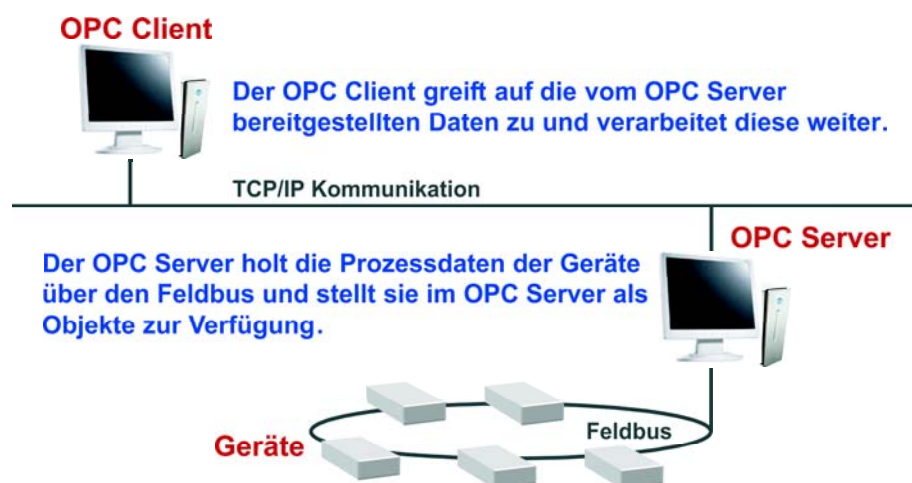
ABBILDUNG 3.9: OPC Kommunikationsweg nach dem Client-Server-Prinzip
