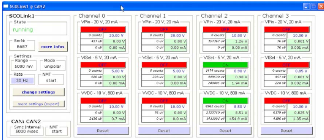
ABBILDUNG 3.11: Grafische Benutzeroberfläche des Frontend Integration Tools für die Versorgung des Optoboards (SC-OLink)
