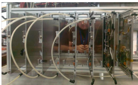
Fig. 5.25 Télescope utilisé pour le test en faisceaux au PS. La chambre à strips est placée en deuxième position en partant de la droite.
