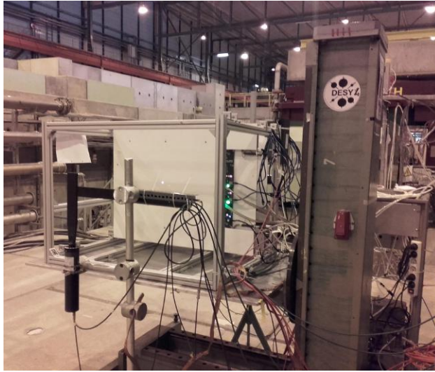
Fig. 6.8 Les deux chambres en Bakélite posées sur la table de positionnement.
