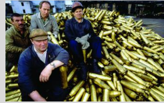
Fig. 3.16 Photo de douilles en laiton de la marine russe réutilisées pour la construction du HCAL.
