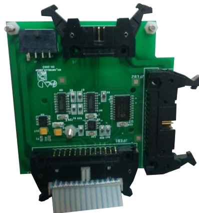
Fig. 4.30 Un DB permettant les configurations des paramètres des FEB par I 2 C ainsi que leur alimentation.
