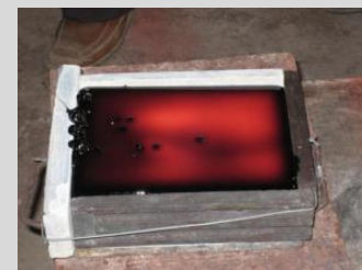
Fig. 5.2 Photo d'une électrode de verre de basse résistivité.
