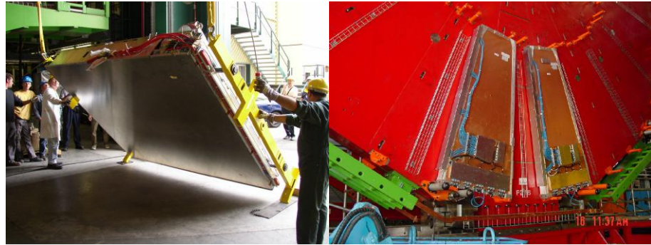
(a) Une cassette contenant une chambre DT et des RPC.
