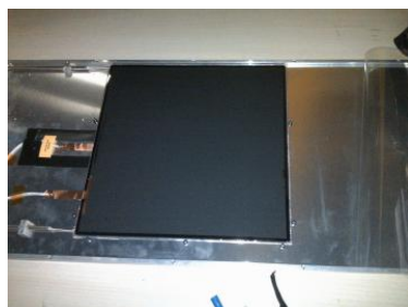
Fig. 5.22 Une GRPC composée de verre de basse résistivité ( \sim 10^{10} \Omega \text{ cm} ).
