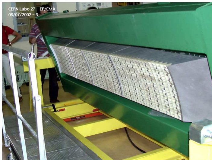
FIGURE 2.4 – Super-module du ECAL sur banc de test.
