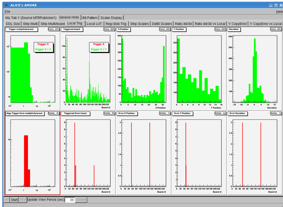
Figure 107 : Histogrammes des réponses de l'algorithme de trigger des cartes locales. Les différentes figures sont détaillées dans le texte.
