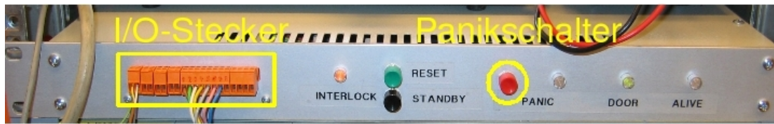
Abbildung 5.7: Die Interlockbox der Slow-Control. Der Panikschalter gibt die Möglichkeit, alle Geräte des Langzeitteststands gleichzeitig abzuschalten.
