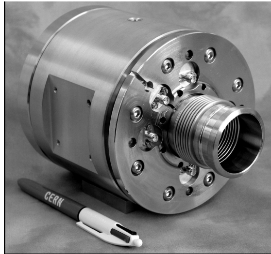
Σχήμα 5.3: Ο Επαγωγικός Αισθητήρας συναρμολογημένος. Στο μπροστινό μέρος υπάρχουν τέσσερις εξοδοί και δύο εισοδοί βαθμονόμησης.[13]
