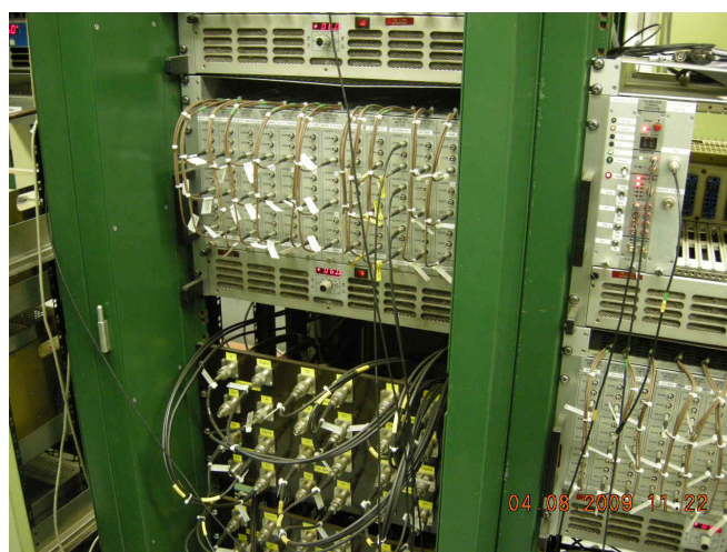
Σχήμα 7.1: Φωτογραφία των αισθητήρων (στο αριστερό μέρος) και της γεννήτριας σημάτων (πάνω δεξιά).
