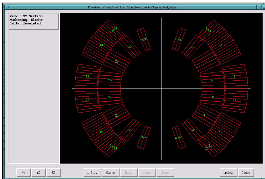
Figura 4.5 Descrizione della cross section della bobina in ROXIE
