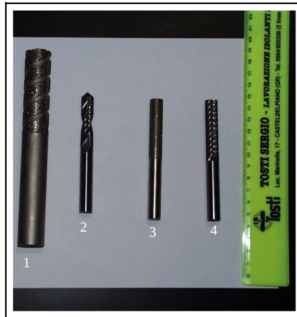
Figura 3.8 Utensileria della macchina a 5 assi utilizzata per la lavorazione degli spaziatori: (1) fresa diamantata da 20 mm utilizzata per la semifinitura dei pezzi grossi, (2) utensile utilizzato per la sgrossatura, (3) mola diamantata fine utilizzata per la finitura, (4) fresa zigrinata da 10 mm per la semifinitura di pezzi di piccole dimensioni.
