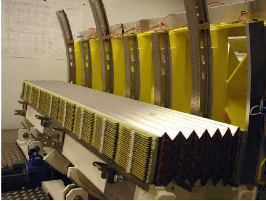
FIG. 5.2 – Montage d'un module du cylindre central. On distingue les plis de l'accordéon. Le module a une longueur de 3.2 m environ.
