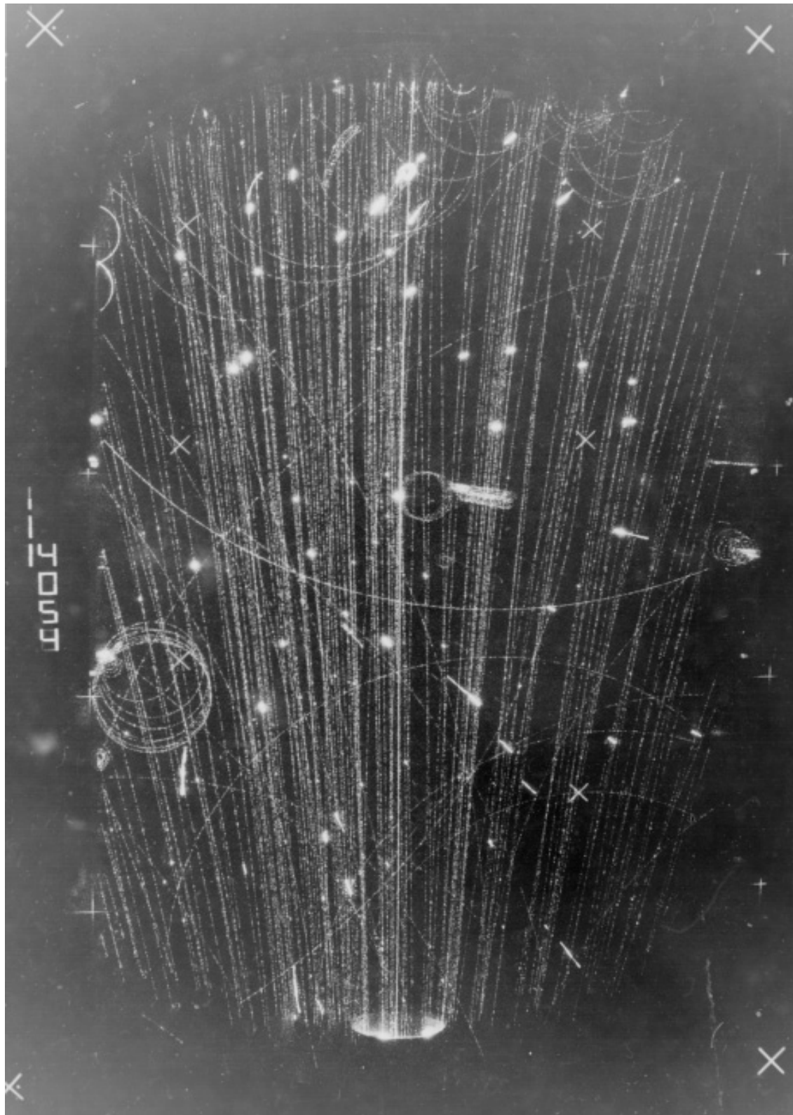
Abbildung 2.5 S+Au Ereignis in der Sweeper-Konfiguration: durch den vor der Streamerkammer angebrachten Sweeper-Magneten werden nur Teilchen mit y_\pi > 3.0 (Vorwärts-hemisphäre) sichtbar. Das erklärt das fast gerade Aussehen der Spuren.
