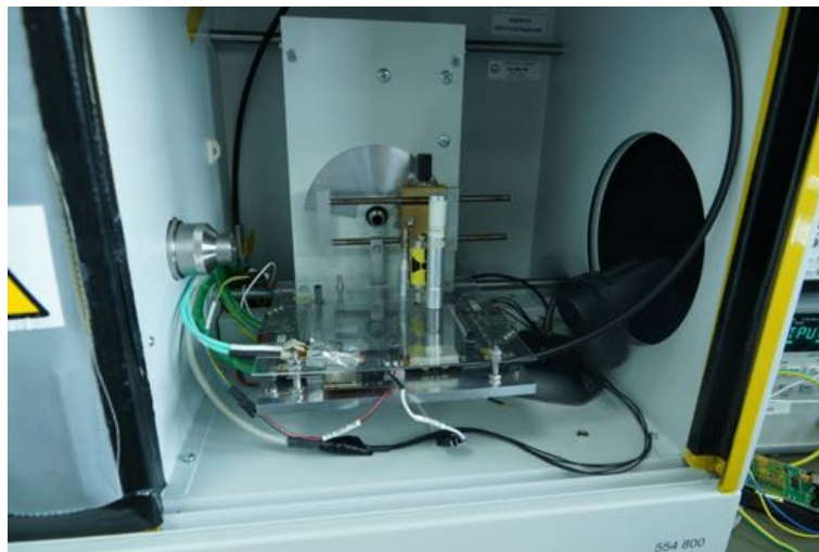
Abbildung IV.13.: Für die Messung von Photonen einer höheren Energie werden Americiumquellen direkt auf die Abdeckung des Moduls gestellt. Aufgrund der geringen Zerfallsrate werden alle vier verfügbaren Quellen auf eine kleine Fläche gestellt, sodass hauptsächlich Chip 1 und Chip 2 das Signal messen.
