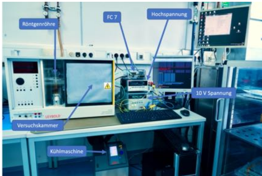
Abbildung III.1.: Der Versuchsaufbau mit dem Röntgengerät. Um äußeren Lichteinfall zu verhindern, ist die Messkammer mit lichtdichter Folie beklebt. Unter dem Tisch befindet sich das Kühlgerät. Rechts neben dem Röntgengerät stehen die Spannungsversorgung und das FC7 sowie der Computer zur Auslese.
