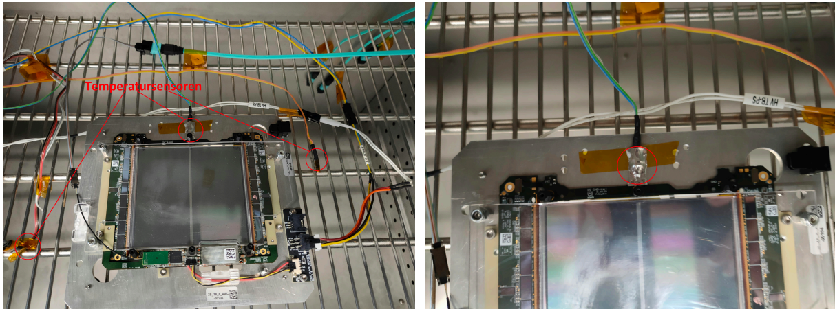
Abbildung 42: Position des Moduls in der Klimakammer und Temperatursensor auf dem Modul.
