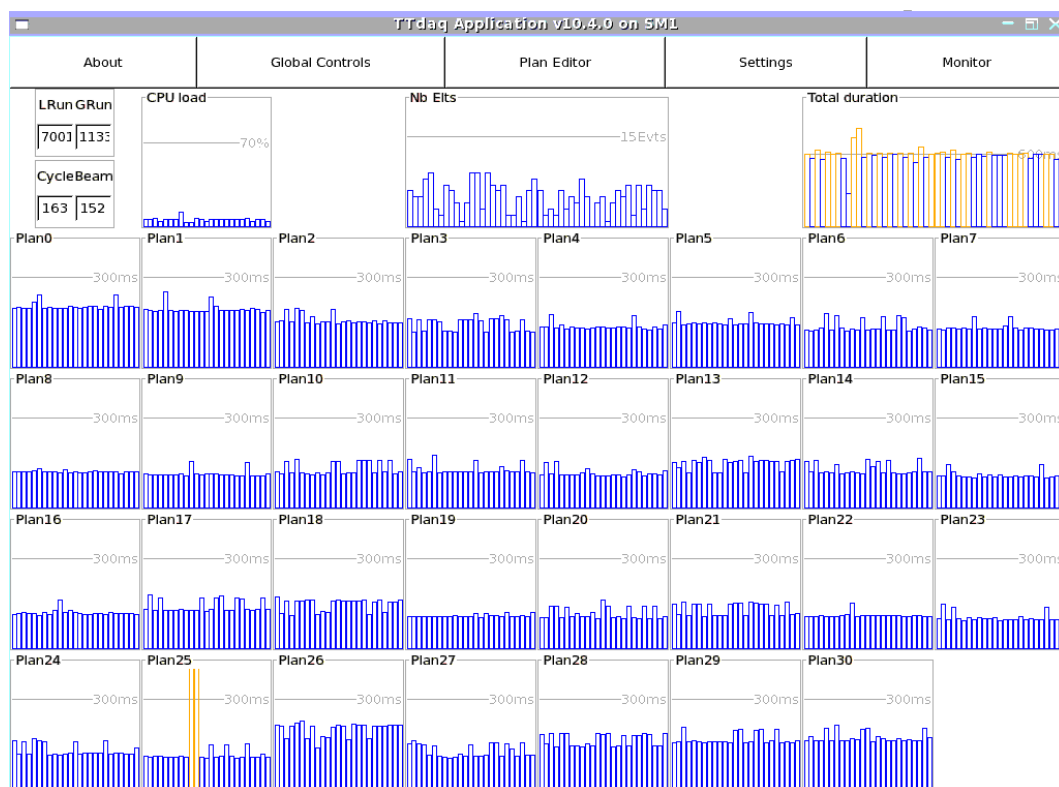
FIGURE 4.14 – Interface de contrôle de l'acquisition du trajectographe : la durée des cycles (en haut, à droite), le nombre d'événements par cycle (en haut, au milieu), l'utilisation de la ressource processeur (en haut, à gauche) ainsi que le temps de transmission des données pour chaque plan par cycle sont visualisables en temps réel et permettent un contrôle de la stabilité de l'acquisition
