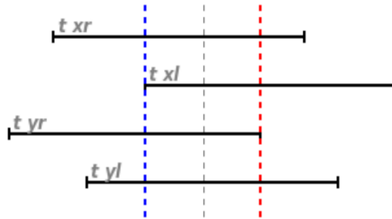
FIGURE 6.1 – Définition du temps d'un plan de trajectographe. Les bornes gauche de chaque barre de 10 ns correspondent aux temps corrigés de chaque capteur. Les pointillés bleus clairs représentent la valeur enregistrée comme temps du plan. La zone entre les lignes en pointillés gras correspond à l'erreur sur le temps enregistré. Si cette erreur est inférieure à 2.5 ns, elle est ramenée à 2.5 ns.
