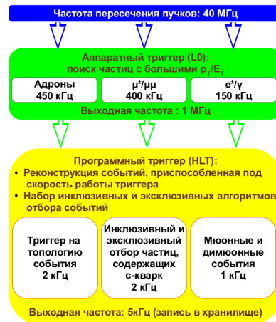
Рис. 14: Блок-схема многоуровневой триггерной системы эксперимента LHCb.
